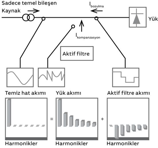
ABB PQF aktif filtreler, kirletici yüke paralel bağlanan güç elektroniği temelli bir sistemdir. Aktif filtre, kirletici yük tarafından çekilen kirli akımı ölçer ve bu akımdaki harmonikleri frekanslarına göre analiz eder. Daha sonra bu harmonik akımlarıyla aynı genlik ve frekansta ama ters fazdaki akımı üreterek şebekeye basar. Bu sayede, aktif filtrenin bağlandığı noktadan şebekeye kadar uzanan kısım, harmoniklerden arındırılmış olur.
