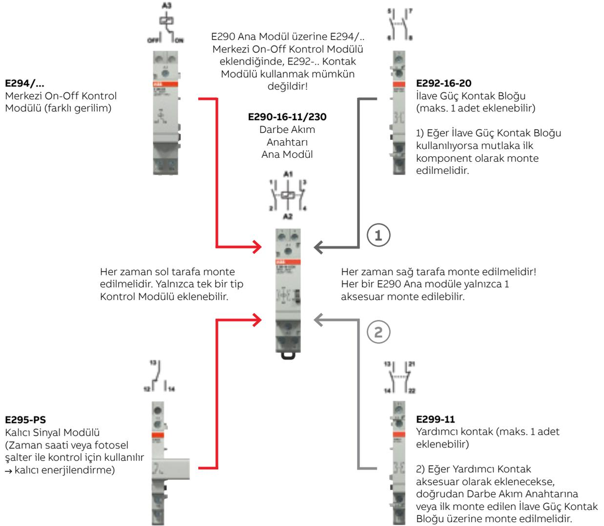
**Emniyet uyarısı:** Eğer birden fazla Darbe Akım Anahtarı yan yana monte edilecekse, iki cihaz arasında ara parça (mesafe parçası) kullanılması önerilir. Böylece ana modüllerin optimum ısı dağılımı garanti edilmiş olur. Ara parça (9 veya 18 mm genişlikte) ZLS725 veya ZLS726 (uygulamaya bağlı olarak) seçilmelidir.
